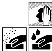
Перед нанесением поверхность должна быть очищена, высушена, обезжирена Жидкостью для удаления силикона / Средством для удаления силикона и отшлифована
