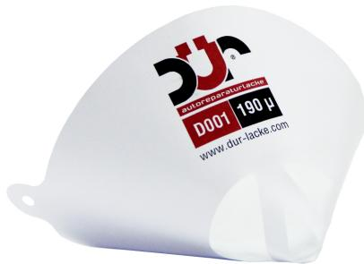
Фильтр-воронка DUR D001 190 мкм применяется для фильтрации лаков, грунтов, акриловых эмалей, базовых покрытий в том числе на водной основе. Нейлоновая фильтрующая сетка имеет ровные ячейки, не подвержена деформации. Бумага сетчатого фильтра не ворсится, обладает низкой впитывающей способностью. Для производства используется клей, устойчивый к любым видам ЛКМ.
